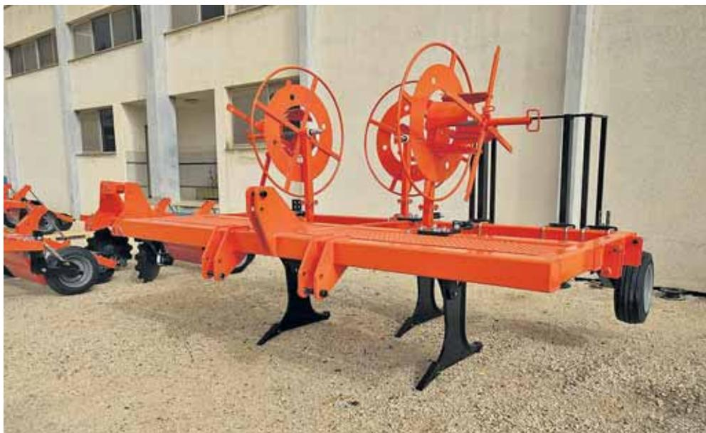
Máquina para la instalación de riego subterráneo.
